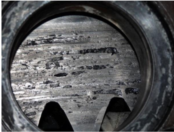
圖 5、轉向軸承面受損狀況
