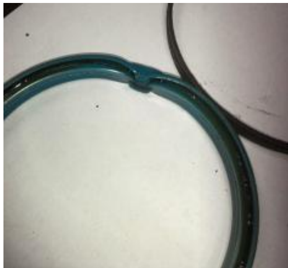
圖 7、液壓缸內部損壞之油封
