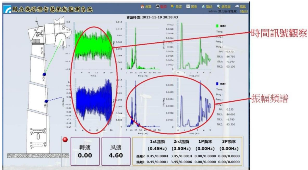
圖 13、即時訊號監測與振幅頻譜分析
