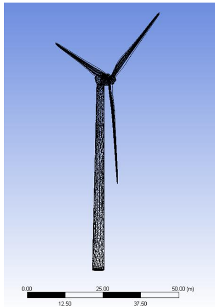
圖 7、風力機整體網格切割
