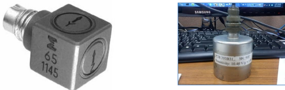
圖 9、振動傳感器，左邊為三軸加速度規，右邊為單軸低頻加速規
