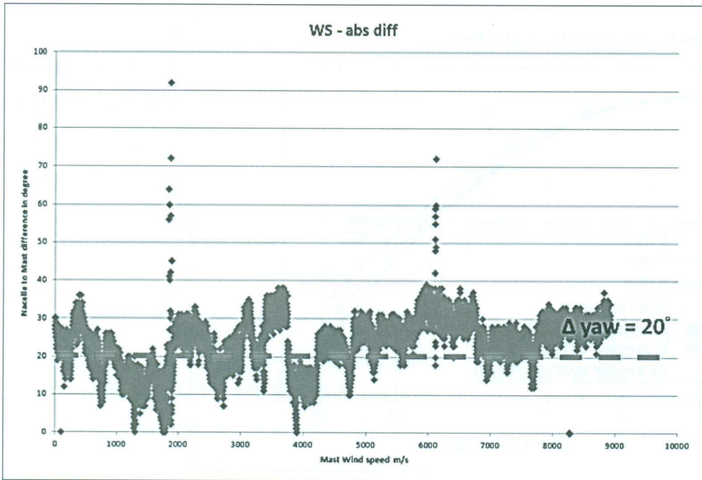
圖 2 風機與測風塔指向誤 差隨風速分布圖(工研 院)
