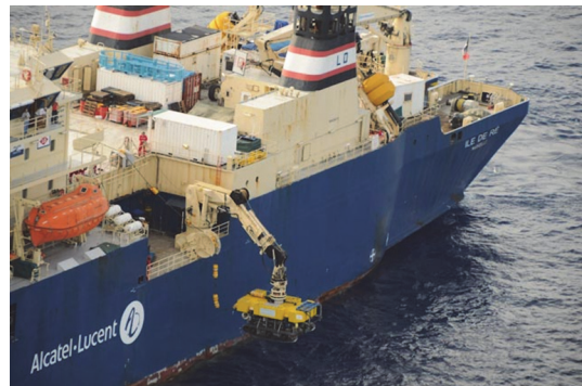
圖 7 佈纜船吊放犁埋機 ROV 作業圖
