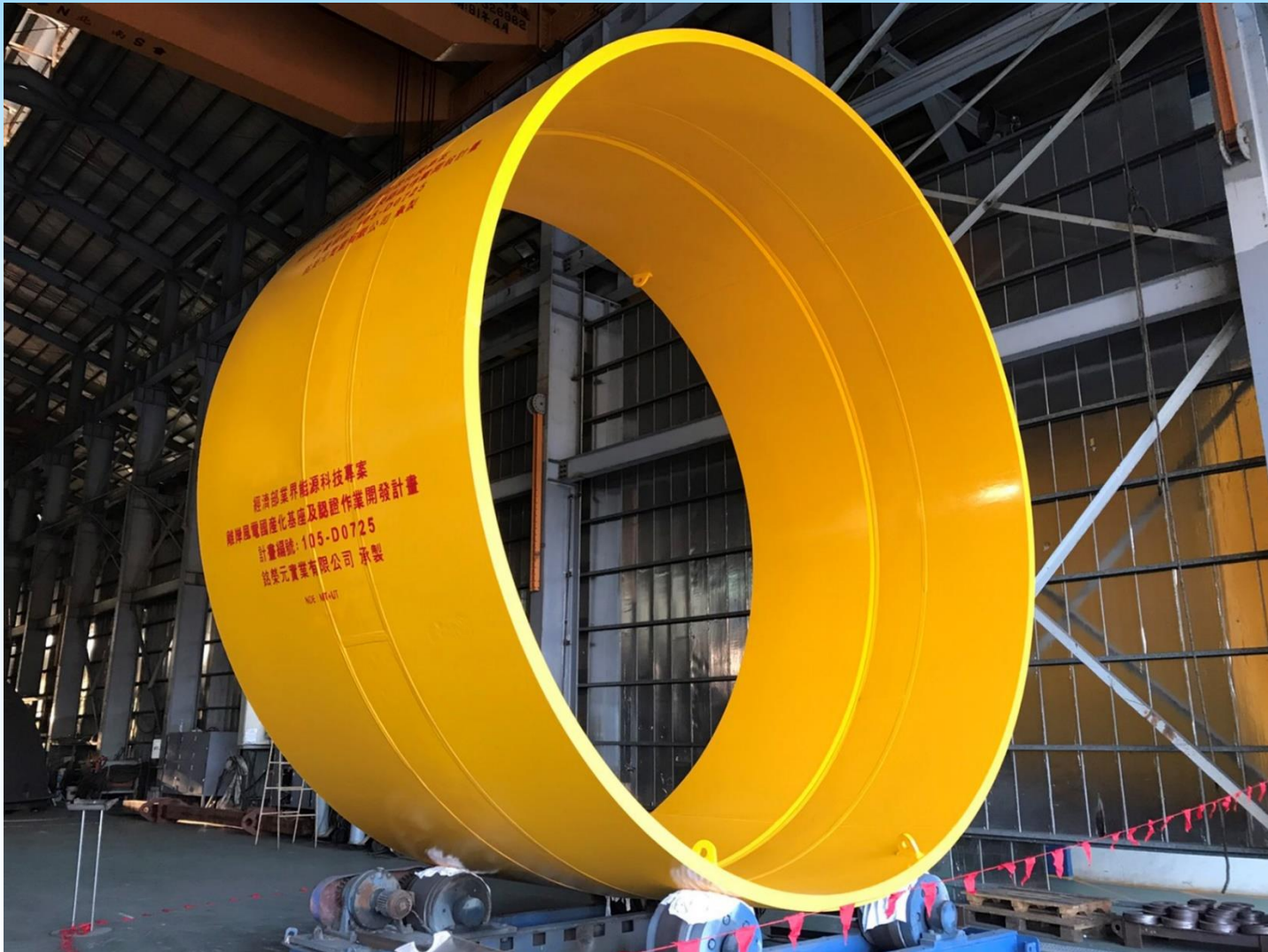
海事基樁指定部分完成作品
